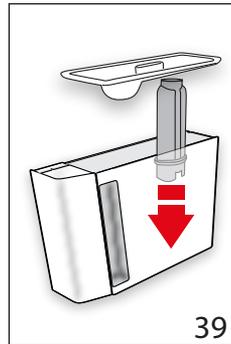
12. (Wenn der Filter installiert war) „FILTER IN DIE VORRICHTUNG EINSETZEN“ (Abb. 39). Den Wahlschalter für „NEXT>“ drücken und den Wassertank entnehmen, den Wasserfilter, falls er zuvor entfernt wurde, wieder einsetzen;
