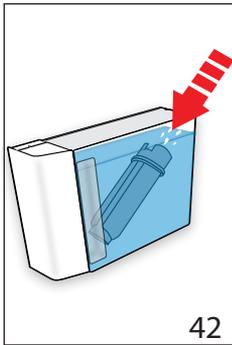
8. „FILTER EINTAUCHEN UND LUFT ENTWEICHEN LASSEN“ (Abb. 42): Den Filter in den Wassertank geben und für etwa zehn Sekunden vollständig eintauchen, dabei neigen und leicht andrücken, um das Entweichen der Luftblasen zu ermöglichen. Den Wahlschalter für „NEXT>“ drücken;
