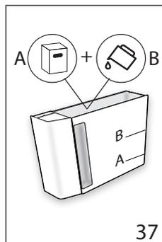
4. „ENTKALKER (FÜLLSTAND A) UND WASSER (FÜLLSTAND B)“ (Abb. 37); den Entkalker bis zum auf der Innenseite des Tanks aufgedruckten Füllstand A (entspricht einer 100ml Packung) in den Wassertank geben; dann bis zum Füllstand mit Wasser (11) auffüllen; den Wassertank wieder einsetzen. Den
