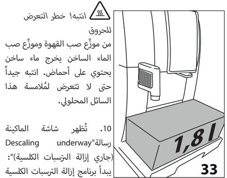
10. تُظهر شاشة الماكينة رسالة "Descaling underway" (جاري إزالة الترسبات الكلسية): يبدأ برنامج إزالة الترسبات الكلسية في العمل ويخرج سائل الإزالة سواء من موّع صب الماء الساخن أو من موّع صب القهوة لتقوم الماكينة أوتوماتيكياً بعمل سلسلة كاملة من عمليات الشطف التي تتخللها فترات توقّف لإزالة بقايا ورواسب الكلس من داخل الماكينة؛
