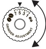
ولكن للحصول على قهوة أكثر كثافة ولتحسين شكل الكريمة، فإنه يجب لف المقبض في عكس اتجاه عقارب الساعة لطريقة ضبط واحدة تجاه الرقم 1 (ليس لأكثر من طريقة ضبط واحدة في المرة، وإلا يمكن للقهوة أن تخرج بعد ذلك على شكل قطرات).
